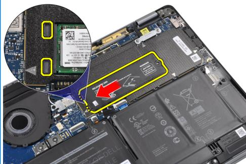
Recoloque a placa térmica da SSD sobre a SSD e fixe-a usando o único parafuso M2 x 2 na placa de sistema.
